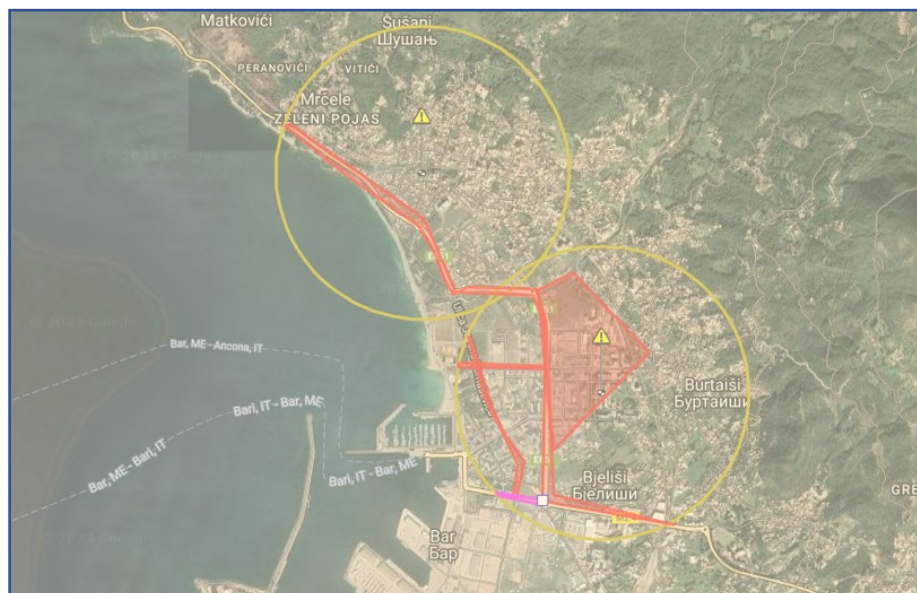
Slika 13. Model buke sa prikazanim regionima Centar 60 dB, putevi 65 dB i ostala površina 55 dB
